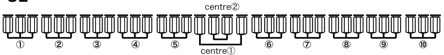
シーリング回路 12回路 30A 20C × 3 (1回路) centre 20C × 2 1KW凸34台
